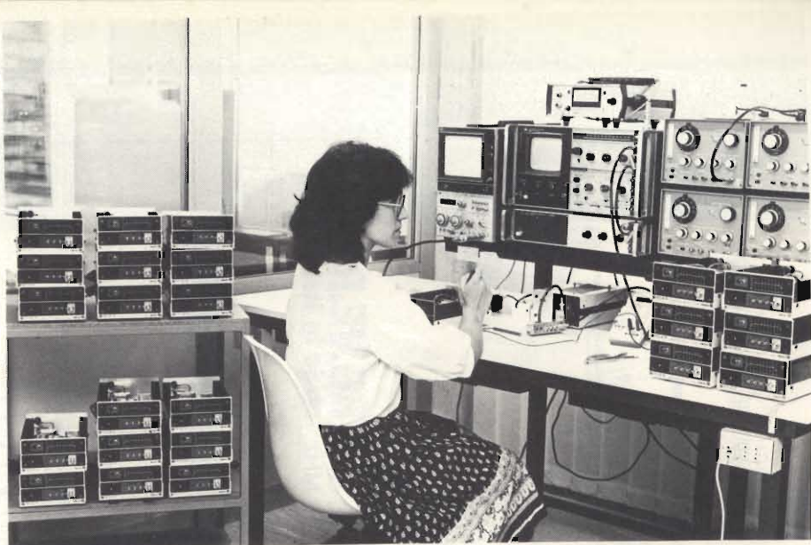
Fig. 2 - Generatore di rumore calibrato CNG 90 nella fase di collaudo di produzione.
