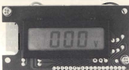
Modulo LCD a selezione automatica delle portate.
